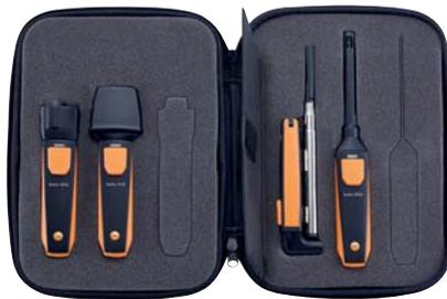
Le kit connecté du climaticien permet de mesurer les vitesses de l'air, l'humidité de l'air, les débits volumétriques et les températures de surface et d'ambiance.
