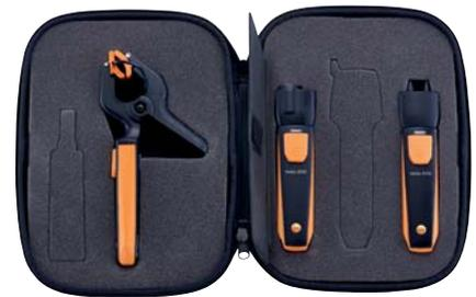
Le kit connecté permet de mesurer et de contrôler toutes les températures et les pressions de l'installation de chauffage. Grâce à la sacoche de transport robuste, les appareils sont toujours disponibles
