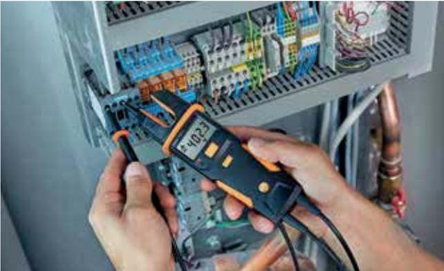
Contrôle de tension sur une pompe à chaleur avec un **testo 755**.
