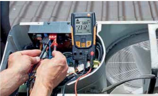
Mesure de la tension sur une unité frigorifique extérieure avec un **testo 760**.
