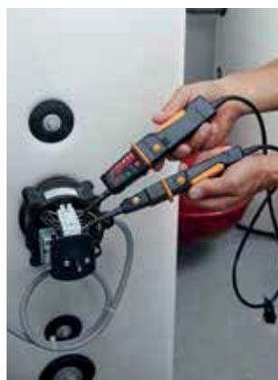
Mesure de tension sur une installation de chauffage.
