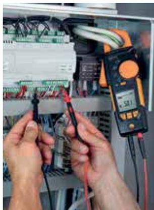
Mesure de la tension sur le tableau de commande d'une pompe à chaleur.
